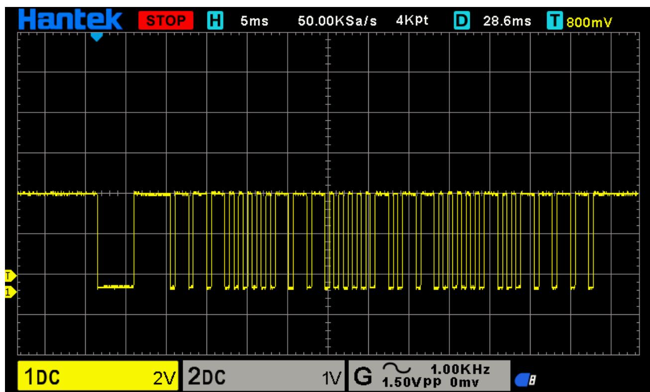
IV - b) Signal mesuré lors d'une communication USB avec un ordinateur
